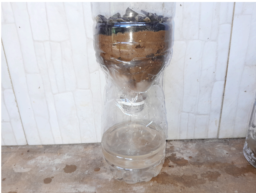
Figura 4.2: Filtragem da água suja.
